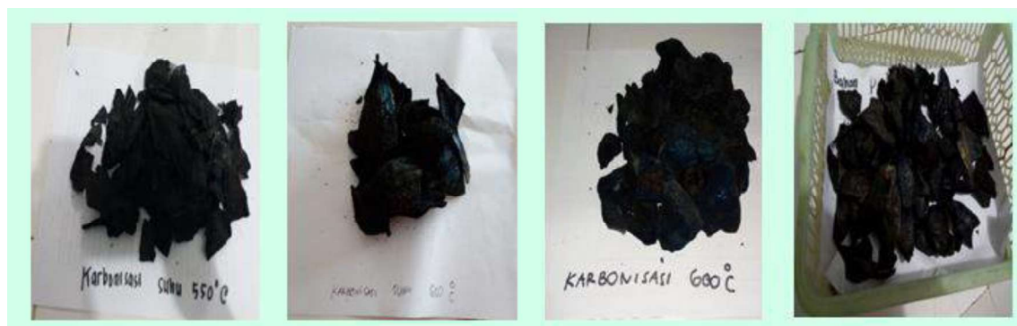
Gambar 1. Bentuk fisik hasil proses karbonisasi kulit Kakao (a) Suhu 550°C (b) Suhu 600°C (c) Suhu 650°C (d) Suhu 700°C
