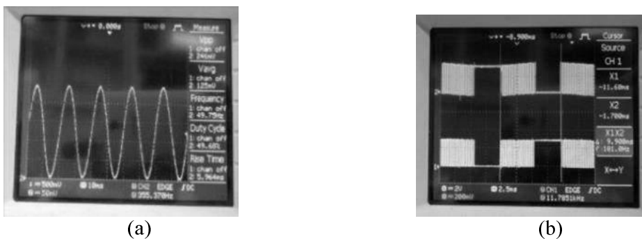
Gambar 7. a) Bentuk sinyal referensi 50Hz, b) Bentuk Pulsa SPWM 50 Hz
