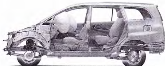
Gambar 2. Sistem proteksi berupa rangka-dasar dan kantong udara. (©Astra-Toyota)
