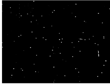
( c ). Mapping Cu ( putih ) , Cu = 0,10%w
