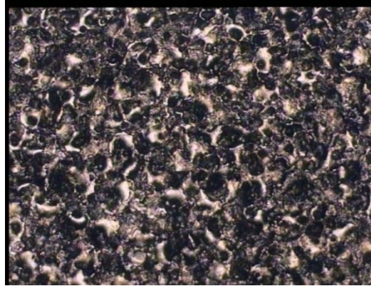
Gambar 9. Foto Permukaan Benda Kerja (100x) untuk Arus = 3A, Arc On-Time = 10 \mu s, Arc Off-Time = 12 \mu s.
