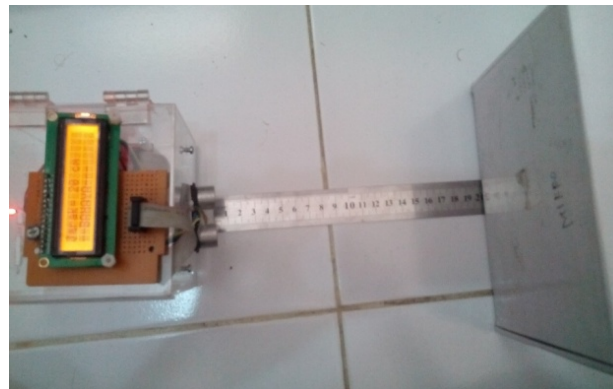
Gambar 7. Pengujian kinerja sensor dengan pembanding mistar
